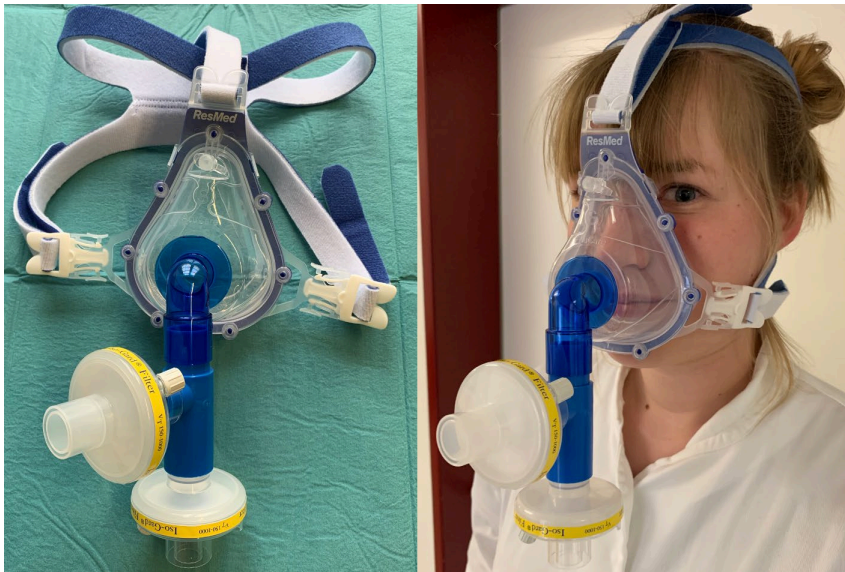
Abb. 3: Eine leckagefreie NIV-Beatmungsmaske mit 2 Filtern zur Reduktion des Ein- und Ausatemwiderstandes ermöglicht den größten Infektionsschutz (über 95% bei dichtem Anliegen).
